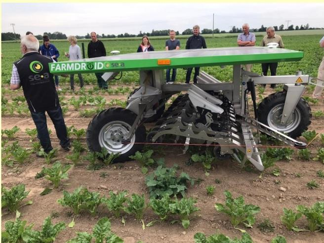
Mit Sonnenenergie betriebener selbstfahrender Hackroboter
